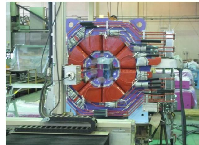
立会試験 2号機 励磁特性 0~800[A] 800~0[A],X=70,Y=0,Z=0[mm]
